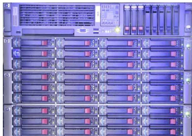
**Abb. 94: 1-TB-Magnetplatten des HP-Rechenclusters**
