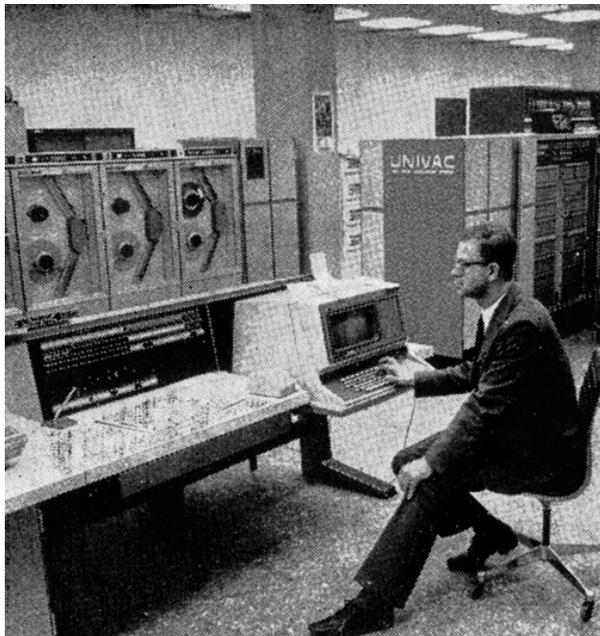
Abb. 7: Rechenzentrumsleiter Dr. Dieter Wall<sup>1</sup> bei der Eröffnung des Rechenzentrums an der Konsole der UNIVAC 1108; links Magnetbandgeräte UNISERVO VIC
