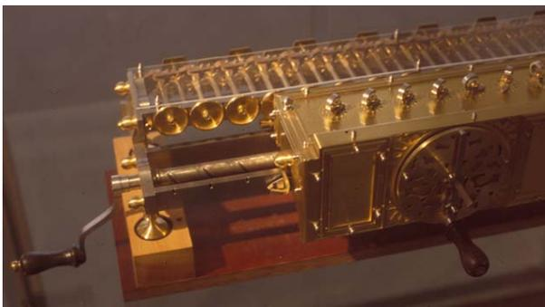
**Abb. 19: Linker Teil mit Spindeltrieb für den Schlitten<sup>2</sup>**
