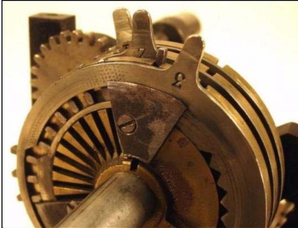
**Abb. 2: Modell eines Sprossenrades – 3 Zähne ausgefahren**
