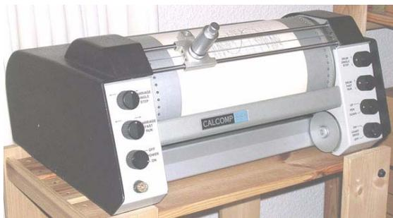
**Abb. 25: Trommelplotter Calcomp 565**
