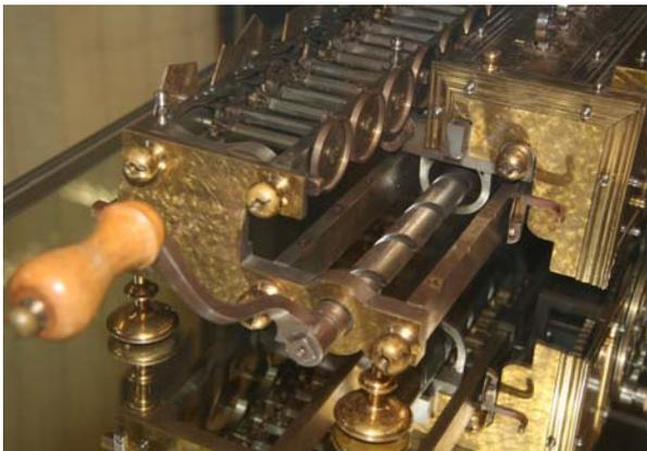
**Abb. 4: Mittels Kurbel und Spindel kann das Eingabewerk am Resultatwerk entlang verschoben werden<sup>2</sup>**
