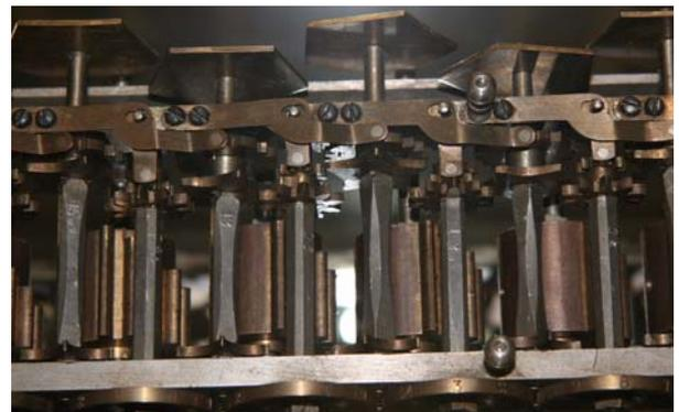
**Abb. 6: Unter dem Ergebniswerk liegende Staffelwalzen; zu erkennen sind auch die Zählräder und die auf der gleichen Vierkantwelle angebrachten Resultaträder. Die auf den dazwischenliegenden Wellen mit Fünfhorn und Muldenrad angebrachten Pentagon-Scheiben dienen zur Anzeige noch nicht vollständig ausgeführter Überträge<sup>4</sup>**
