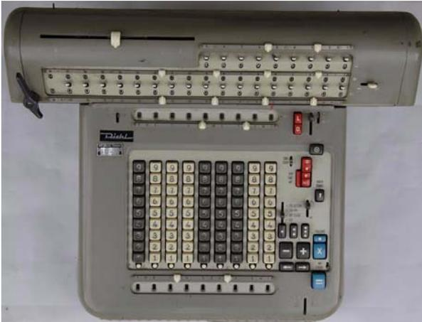
**Abb. 46: Diehl VSR18 (Vollautomat – Speicher – Rückübertragung – 18 Stellen im Resultatwerk)**
