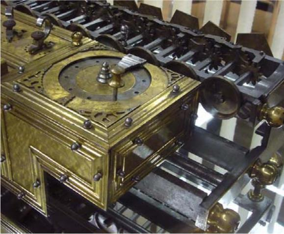
**Abb. 18: Umdrehungszählwerk auf dem Schlitten und rechter Teil des Resultatwerks<sup>1</sup>**
