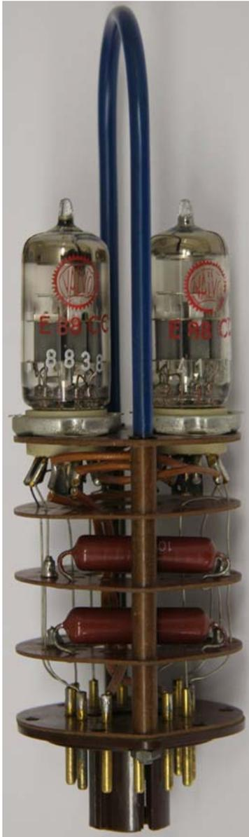
**Abb. 44: Röhren-Steckbaugruppe mit zwei Röhren E88CC**
