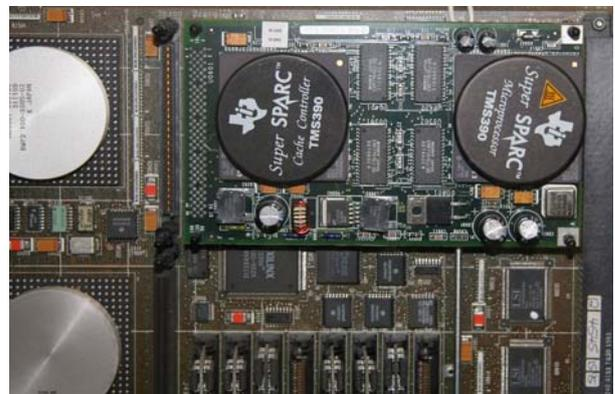
**Abb. 58:** Ausschnitt der CPU-Platine der Sun SPARCstation 10 mit zwei Mikroprozessoren SuperSPARC TMS 390 auf „Daughterboard“
