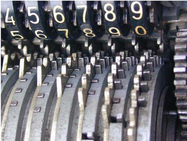
**Abb. 20: Original Odhner Modell 139, Blick auf die Sprossenräder: die ausgefahrenen Zähne (Stifte) sind deutlich zu erkennen.**
