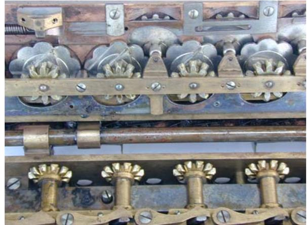
**Abb. 30:** (Obere Bildhälfte: Schlitten hochgeklappt) Beim Zehnerübertrag schiebt die Excenterscheibe unter dem Zählrad (links oben gut zu erkennen) den Einzahn in die Übertragsposition (über den Hebel am unteren Bildrand)
