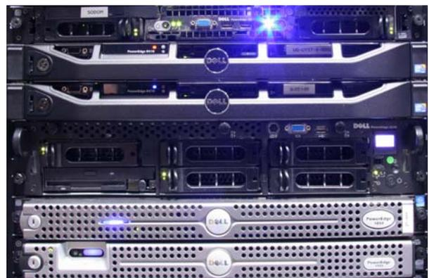
**Abb. 77: Dell Rack-Server, von oben nach unten: PE 1850, PE R410 (2 x), PE 2650 und PE 1850, PE 1950**
