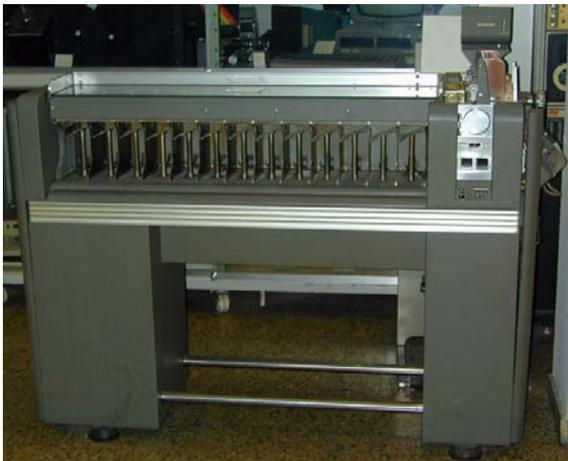
**Abb. 10: Lochkartensortiermaschine IBM 82 im Rechnermuseum der GWDG**
