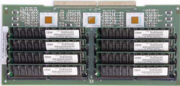
**Abb. 73: Eine RS/6000-SP-Power2-SC-Speicherplatine**
