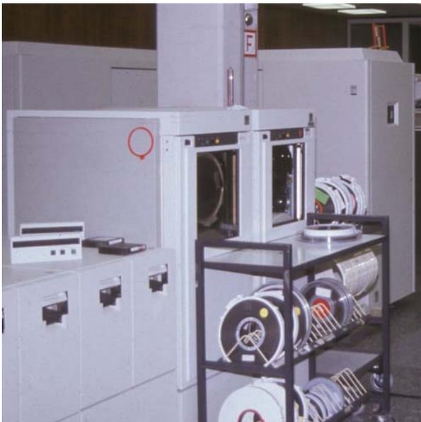
**Abb. 46: Magnetbandgeräte der IBM 3090: links Kassetten-Laufwerke IBM 3480, rechts Spulen-Laufwerke IBM 3422**
