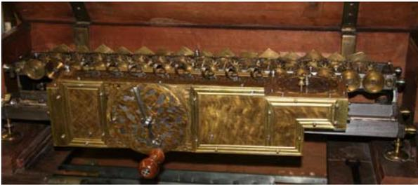
**Abb. 3: Vorn der verschiebbare Schlitten mit Kurbel, achtstelligem Eingabewerk und Umdrehungszählwerk<sup>1</sup>**
