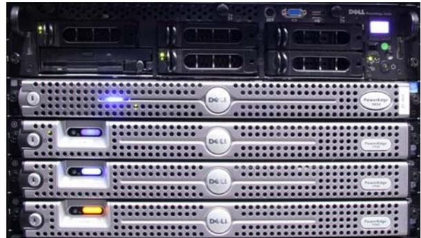
**Abb. 76: Dell Rack-Server, von oben nach unten: PE 2650 (ohne Frontabdeckung), PE 1850 und 3 x PE 1650**
