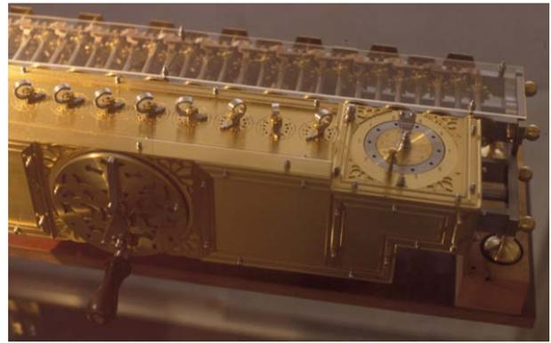
**Abb. 20: Rechter Teil mit Umdrehungszählwerk<sup>3</sup>**
