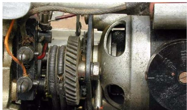
Abb. 38: Der Antriebsmotor mit Stiften für den Gerätestecker (links) und Wählscheibe für die Versorgungsspannung (rechts)
