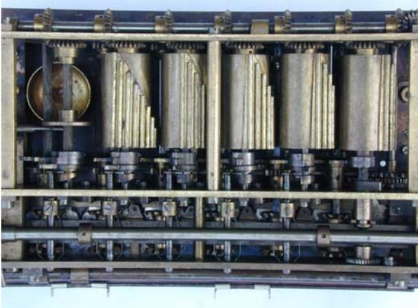
**Abb. 28:** Blick von unten auf alle Staffelwalzen und die auf der gleichen Welle angebrachten Einzähne. Dazwischen jeweils die Welle mit dem Mechanismus zum Zurückschieben des Einzahns nach erfolgtem Übertrag (siehe auch Abb. 31)
