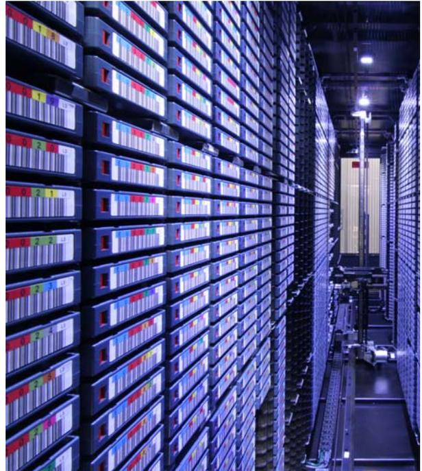
**Abb. 81: LTO-3-Bandroboter „adic Scalar 10K“, Blick ins Innere**
