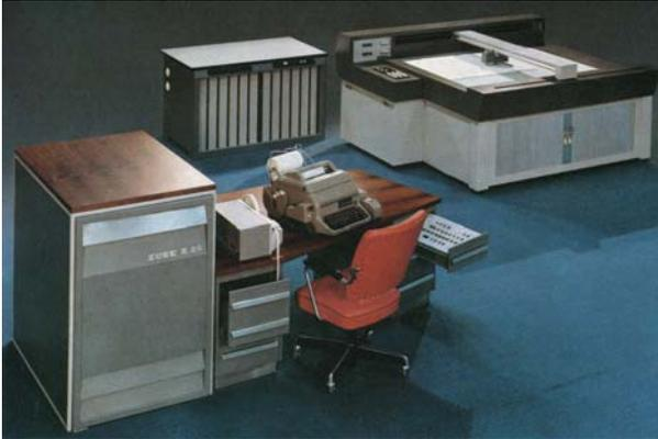
**Abb. 57: Der Transistorrechner Z25 und der Zeichentisch Graphomat Z64**
