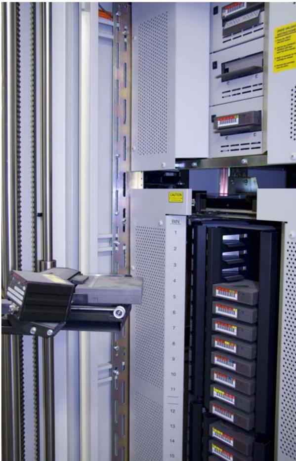
**Abb. 67: Einblick in den Bandroboter Digital TL820, rechts oben drei Laufwerke, links der Roboter-Greifer mit Strichcode-Leser**
