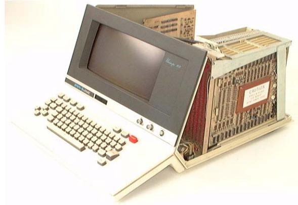
**Abb. 26: UNISCOPE 100 – Blick auf die Elektronikplatinen: rechts außen Bildschirm- und Speicher in Ferritkerntechnik**
