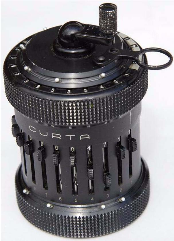
**Abb. 50: Curta Modell II mit elf Stellen im Eingabewerk, acht Stellen im Umdrehungszählwerk und 15 Stellen im Resultatwerk**
