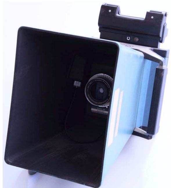
**Abb. 29: Polaroid-Kamera vom Typ Tektronix C10**
