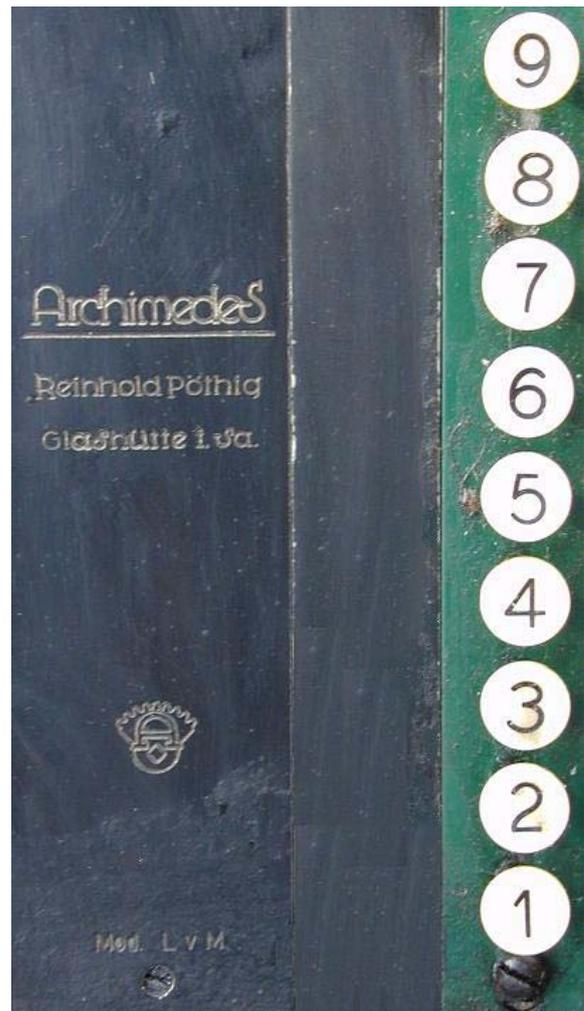
Abb. 37: Beschriftung der Maschine, daneben die höchstwertige Stelle der Eingabe-Volltastatur
