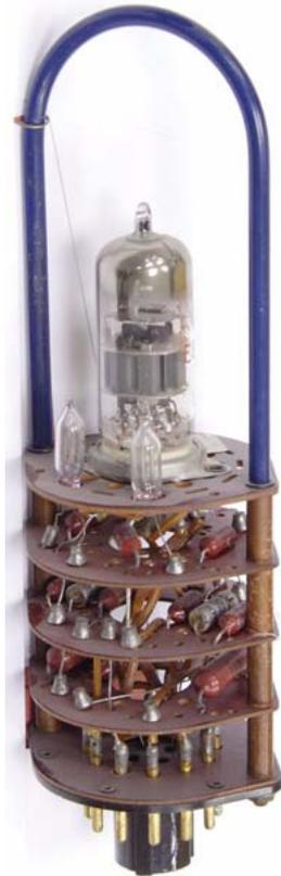
**Abb. 36: Röhren-Flip-Flop-Steckbaugruppe**
