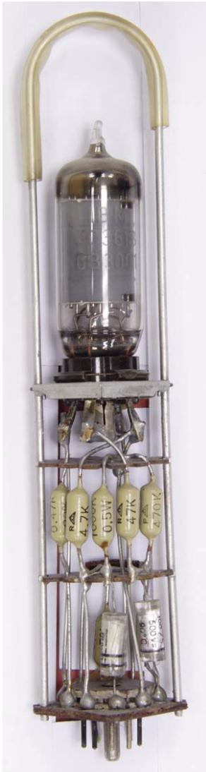
**Abb. 9: Flip-Flop-Röhrensteckeinheit der IBM 650**
