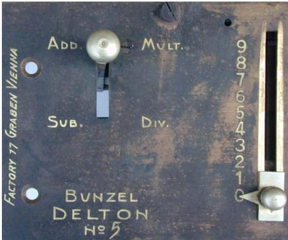
Abb. 32: Der Umschalthebel „ADD./MULT“ / „SUB/DIV“, dessen Fortsetzung unter die Einstellplatte in Abb. 34 zu sehen ist
