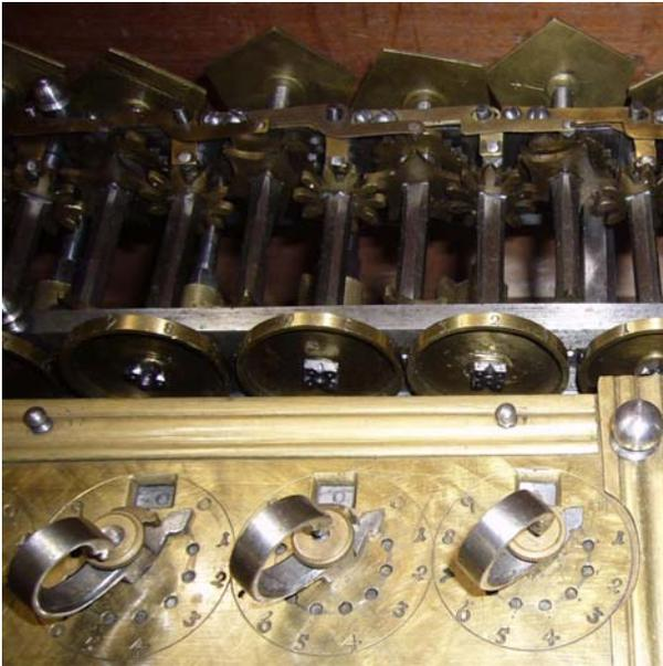
**Abb. 7: Drei Einstellräder mit Schaulöchern und Teil des Ergebniswerks mit Ziffern auf dem Rand der Resultaträder<sup>1</sup>**
