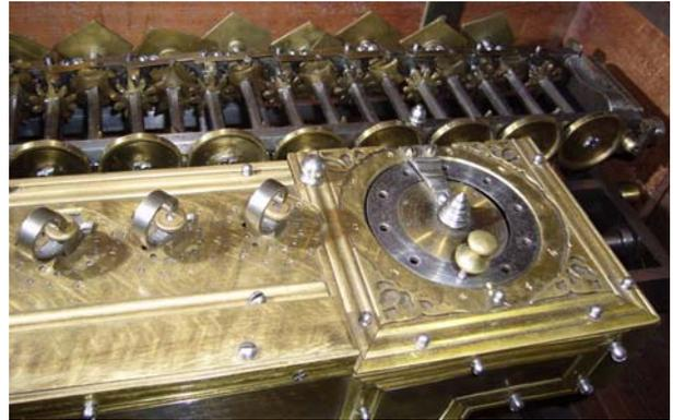
**Abb. 5: Einer-, Zehner- und Hunderterstelle des Eingabewerks und Umdrehungszählwerk; im Resultatwerk sind zu erkennen die Resultaträder, die Zählräder, die Muldenräder und die Pentagon-Scheiben<sup>3</sup>**
