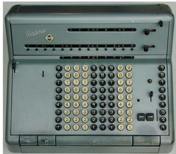
**Abb. 49: Die „Badenia Modell TE 13“; rechts die Tastenreihe für Multiplikator bzw. Divisor**
