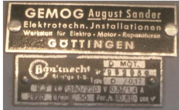
Abb. 8: Firmenschild auf dem Antriebsmotor des Trommelspeichers der G1
