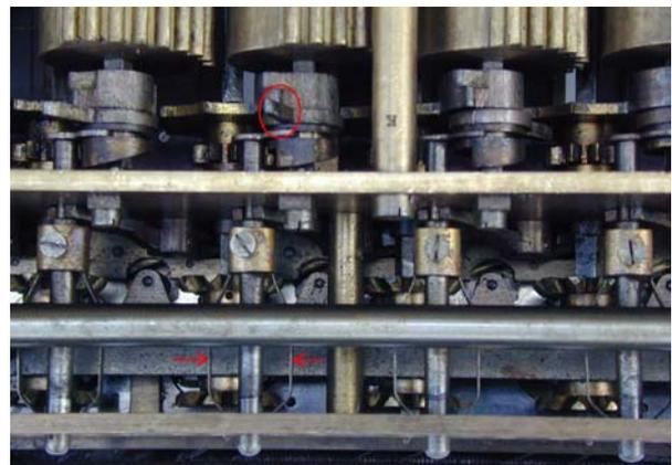
**Abb. 31:** (Blick von unten:) Der in Übertragsposition gebrachte Einzahn (Kreis) wird zum Ende der Kurbeldrehung von Stahlfedern (Pfeile) dort gehalten, bis er wieder in die Ruheposition geschoben wird
