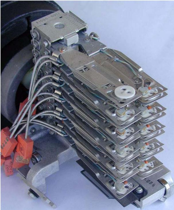
**Abb. 10: Schreib-/Leseköpfe am Linearmotorantrieb der U8440**
