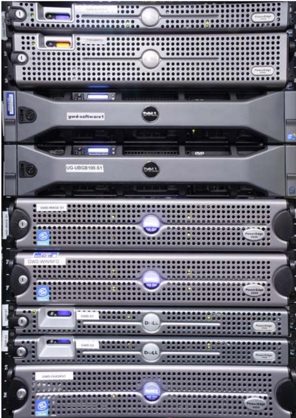
**Abb. 82: Einige Server des Active Directory, von oben nach unten: „GWD-WinTS1“ (PE 1950), „GWD-WinTS2“ (PE 2950), „GWD-Software1“ (PE D710), „UG-UBGB100-S1“ (PE D710), „GWD-Image-S1“ (PE 2650), „GWD-WININFO“ (PE 2650), „GWD-S1“ (PE 1950), „GWD-S2“ (PE 1950), „GWD-FAXSRV1“ (PE 2650)**
