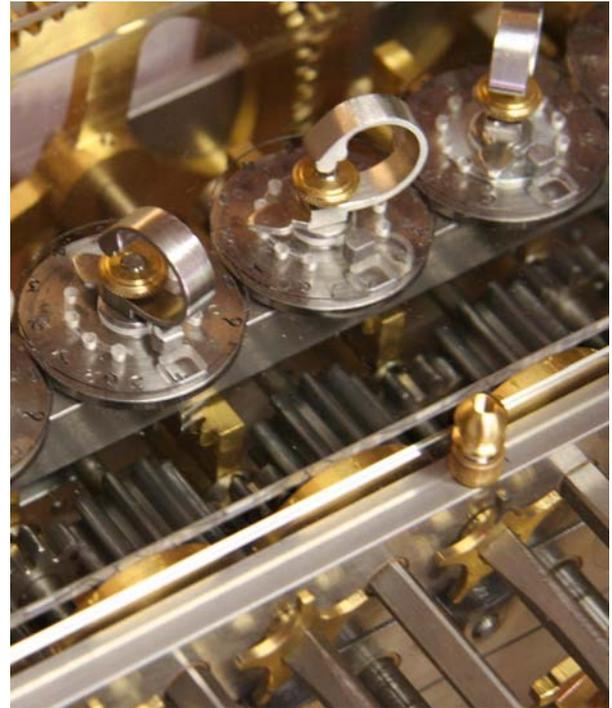
**Abb. 8: Einstellräder, unter dem linken ist das Ende einer Zahnstange sichtbar; unter dem rechten Fünfhorn ist ein Zweihorn zu erkennen<sup>2</sup>**
