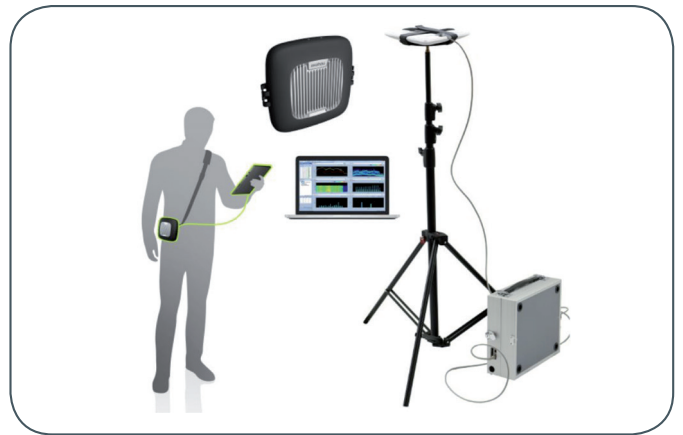
3_Klassische Anordnung bei der WLAN-Ausleuchtung
