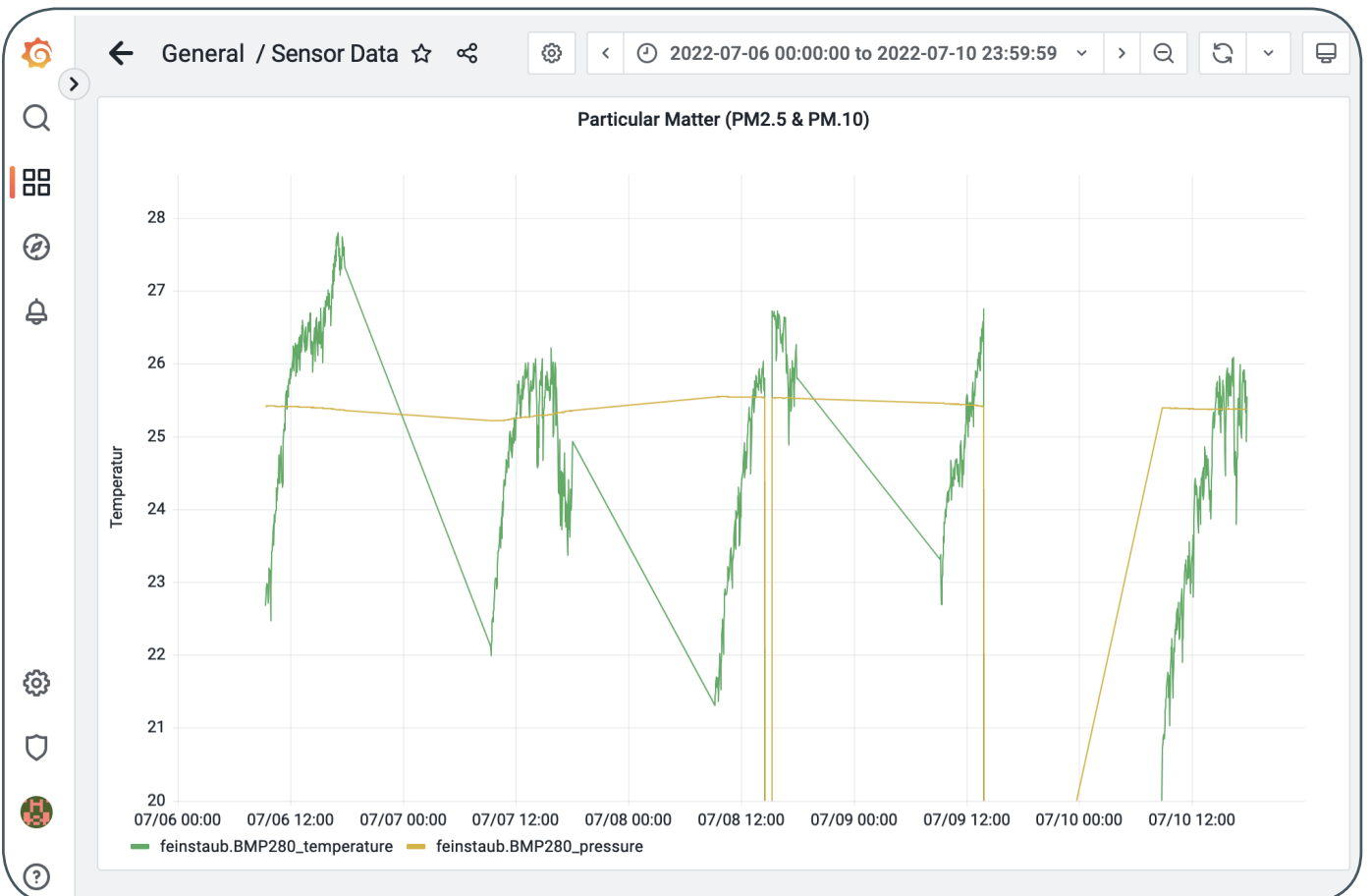
4_Temperaturmessung auf der IdeenExpo 2022. Der Temperaturverlauf zeigt ein Aufheizen der Hallen während der Öffnungszeiten. Es sind Messfehler des Sensors zu erkennen, die durch Berührung der Kabel oder des Sensors bei der Vorstellung des Experiments entstanden sind.
