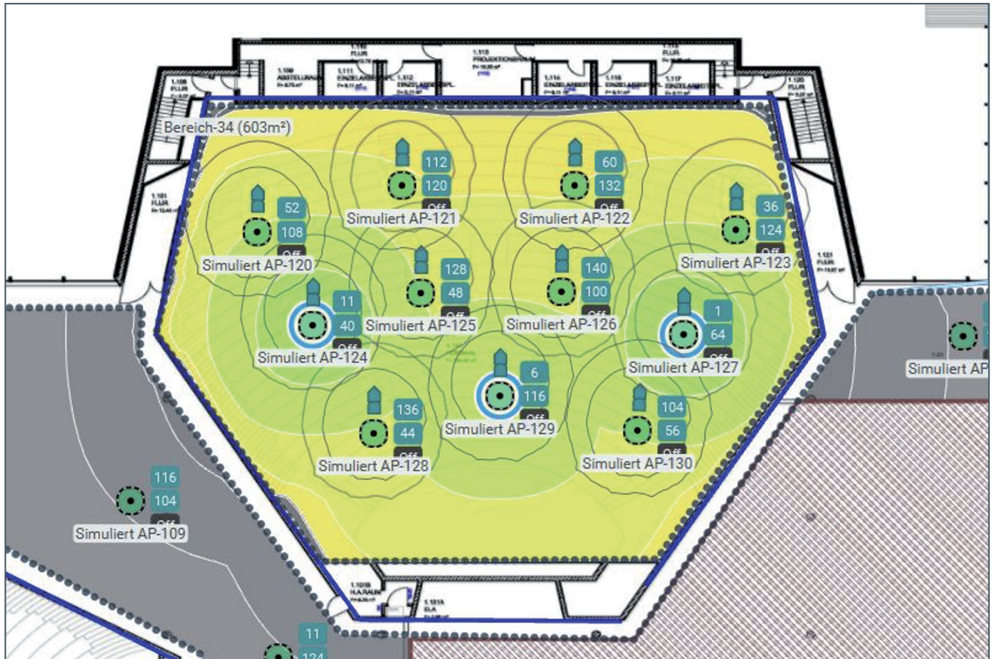
8_Ausleuchtungs-HeatMap des Hörsaals 011 im ZHG
